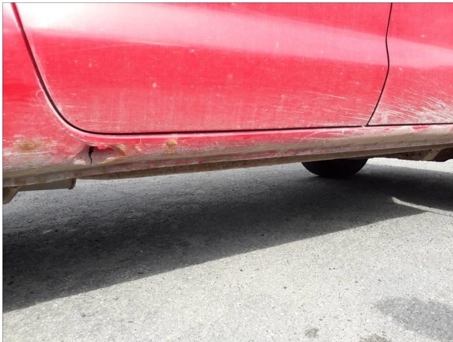
1. att. Sliekšņa korozijas bojājums
