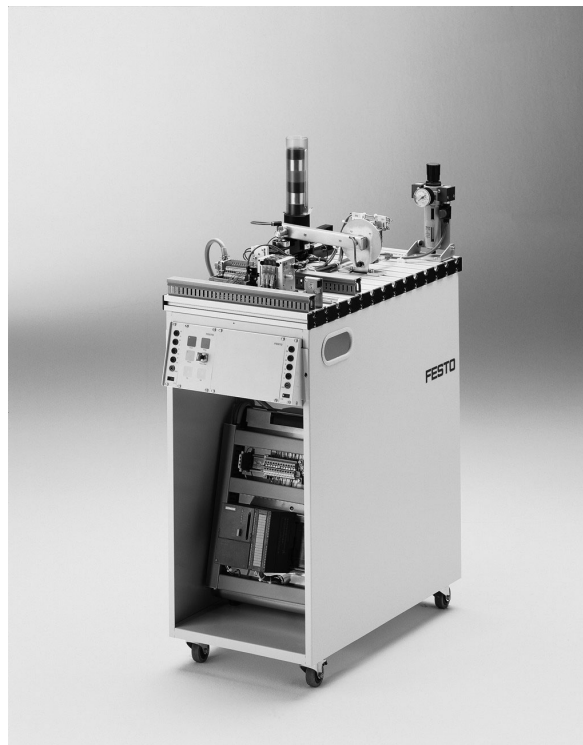
Station Verteilen mit Wagen, Bedienpult und SPS Board
