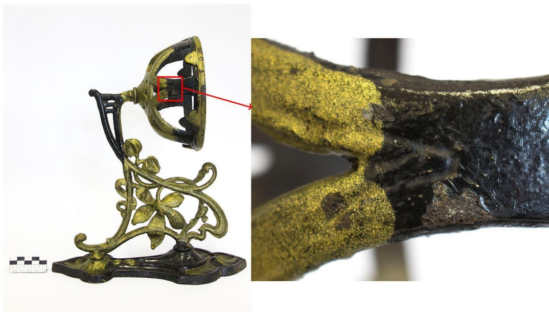
6. attēls. Redzami krāsas slāņi un korozijas produkti
