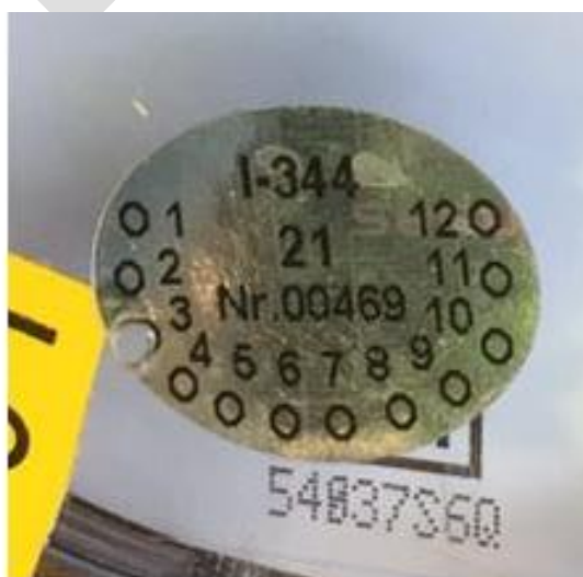
1. attēls. Manometra verifikācijas uzlīme
