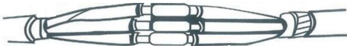
1. attēls. Zemsprieguma kabellīnijas savienojošā uznavu
