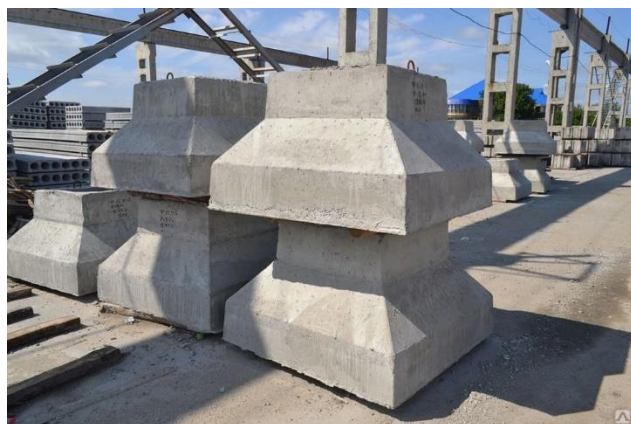
3. attēls. Dzelzsbetona kolonnas pamata pēdas montāža
